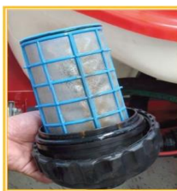
Fig.16. Filtro en buen estado y adecuado.
