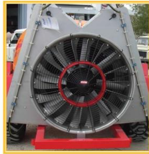
Fig. 20. Ventiladores con resguardos de protección en la zona de impulsión del aire (izquierda) y en la zona de aspiración (derecha).
