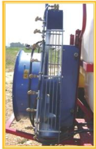
Fig. 20. Ventiladores con resguardos de protección en la zona de impulsión del aire (izquierda) y en la zona de aspiración (derecha).
