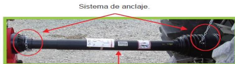
Fig. 4. Resguardo del eje de transmisión en buen estado y sistema de anclaje.
