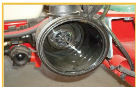
Fig. 15. Dispositivo que no permite que se vacíe el depósito.
